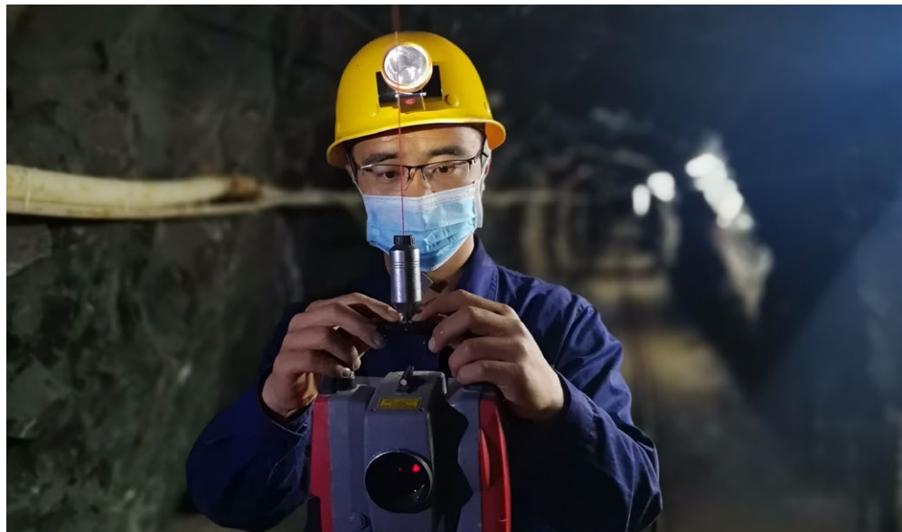
五龙矿业生产技术部工程师正在进行采区巷道导线测量
